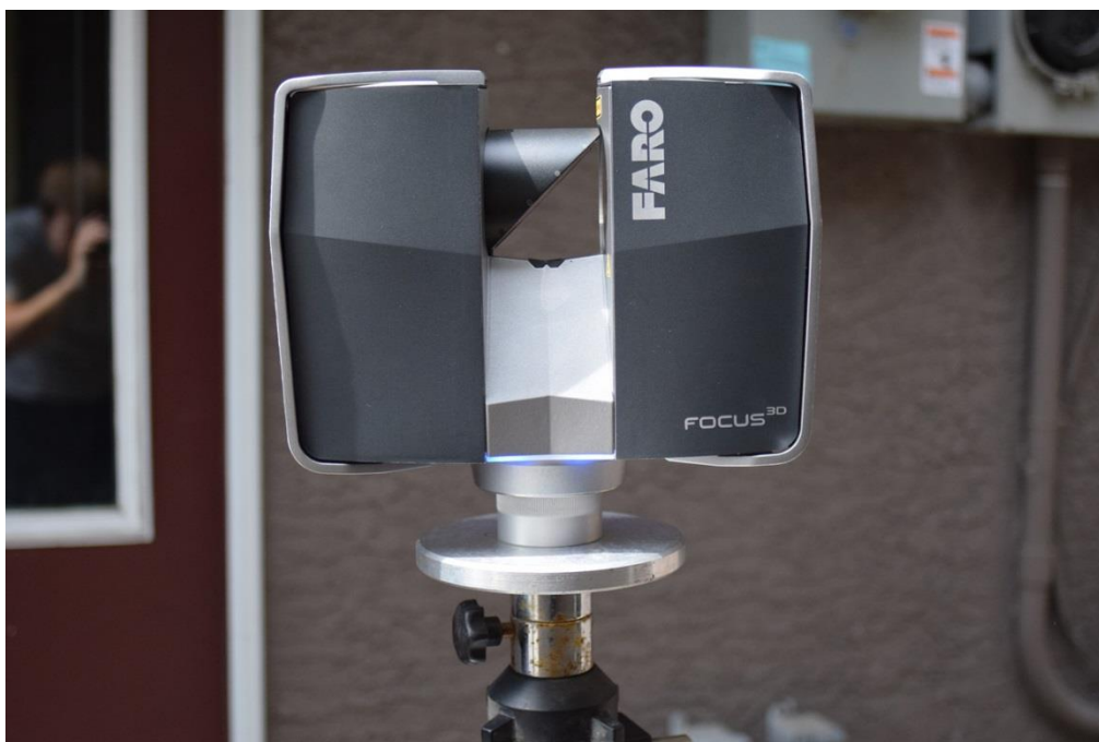
Рисунок 1. Внешний вид 3D-сканера модели FaroFocus 3D
