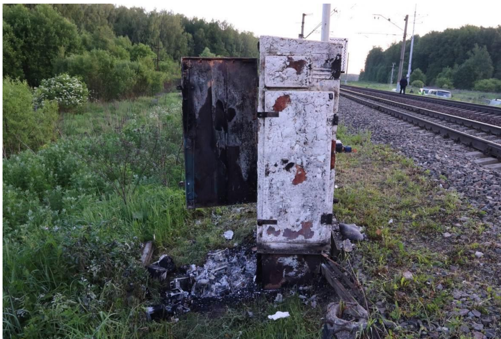
Рис. 3. Внешний вид сгоревшего релейного шкафа
