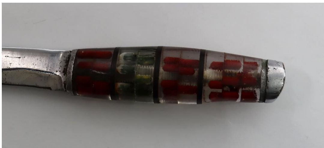
Рис. 7. Рукоять самодельного ножа, изготовленная из полиметилметакрилата
