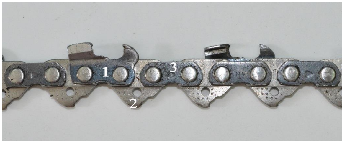
Фото 7. Фрагмент пильной цепи: 1 – режущее звено; 2 – ведущее звено (хвостовик); 3 – соединительный элемент
