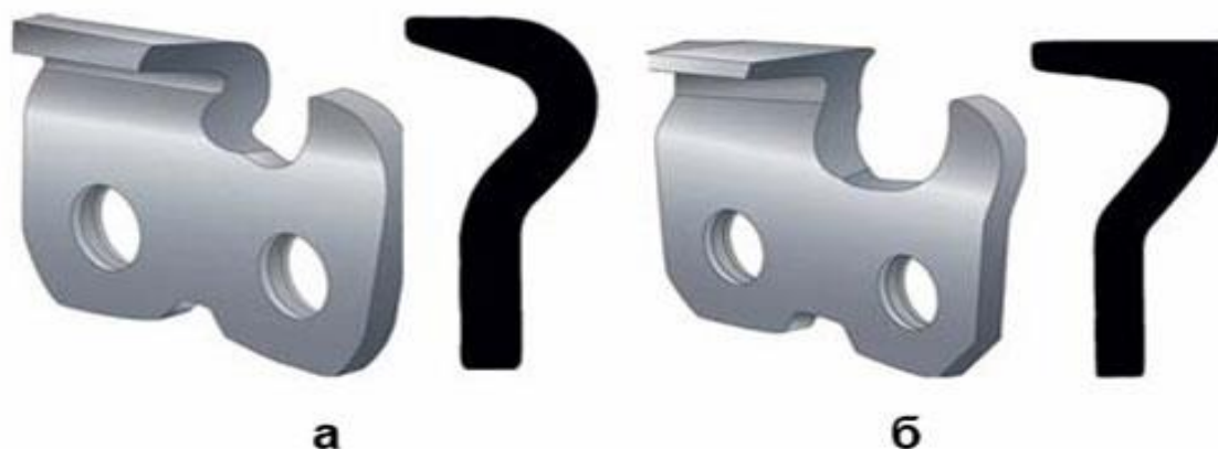
Рис. 1. Рабочие элементы пильной цепи: а – чипперного типа; б – чизельного типа
