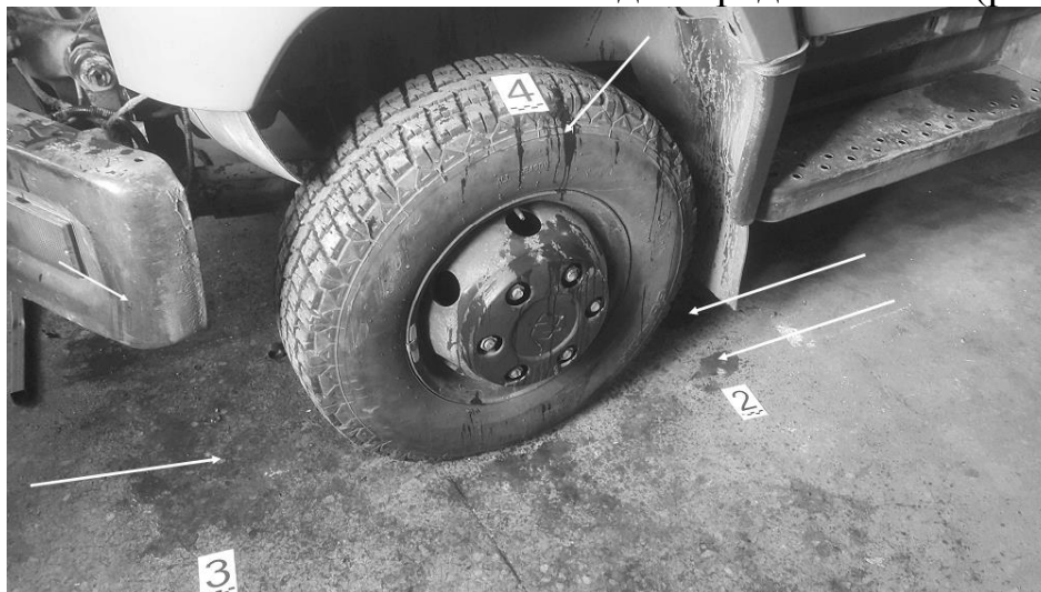
Рис. 4. Следы растекания жидкости под автомобилем ЗИЛ-5301 «Бычок»
