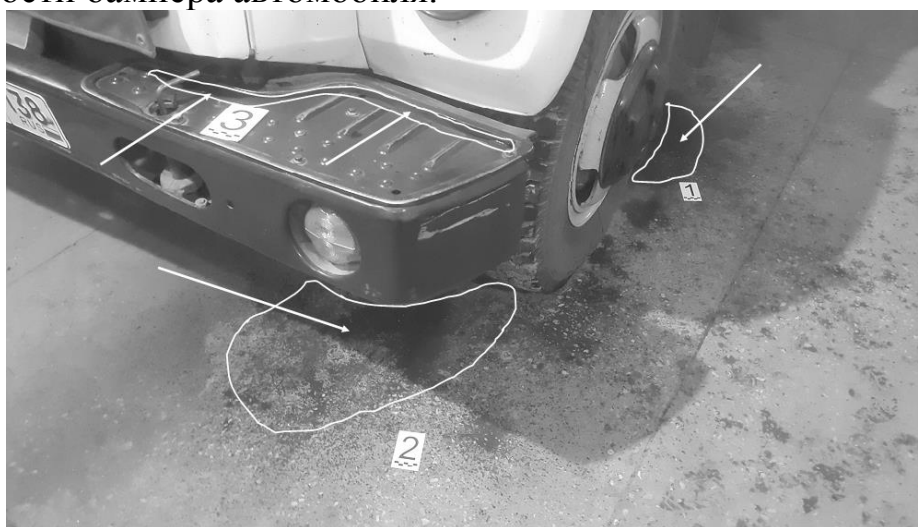
Рис. 2. Следы растекания жидкости на автобусе КАВЗ 32765 (выделенные области)
