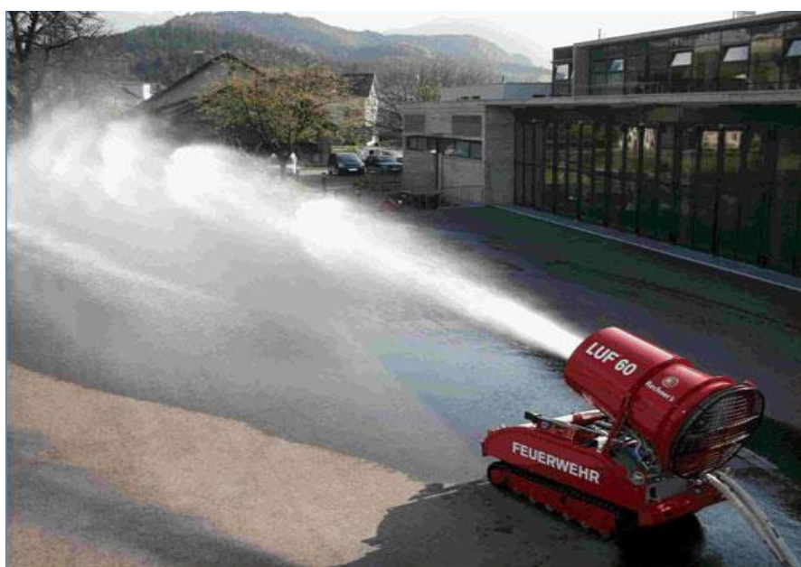
Рис. 4. Мобильная установка пожаротушения LUF-60
