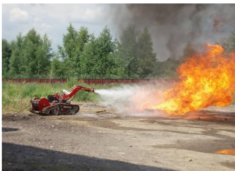
Рис. 3. Мобильный робототехнический комплекс разведки и пожаротушения
