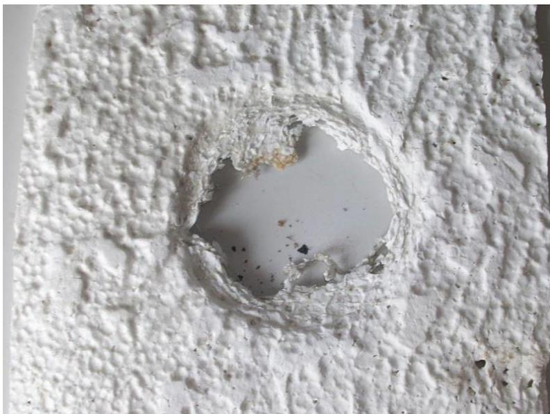
Рис. 11. Образец полистирола (в виде потолочной плитки), подверженный тепловому воздействию ЛНОН мощностью 60 Вт
