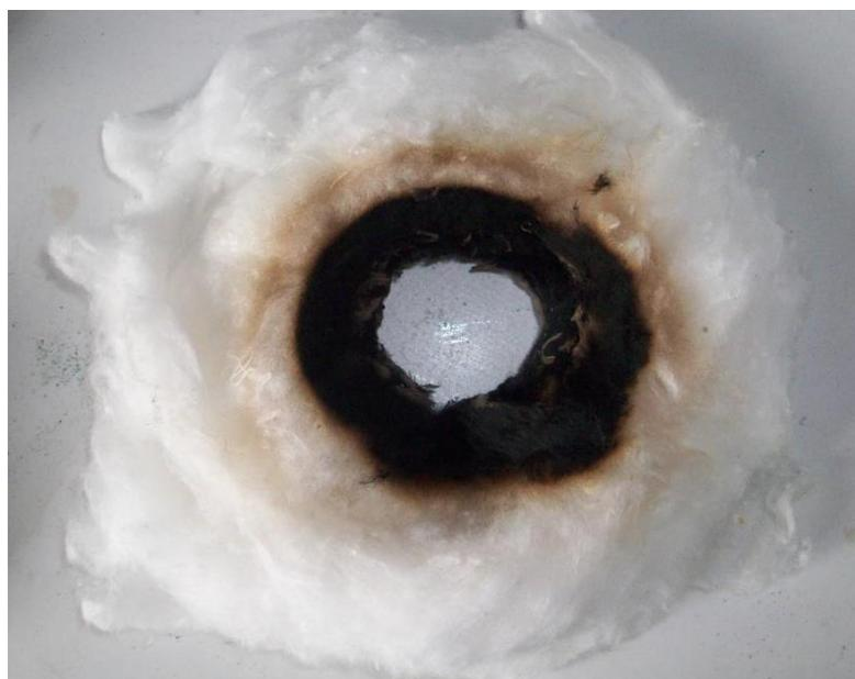
Рис. 2. Образец хлопчатобумажной ваты, подверженный тепловому воздействию ЛНОН мощностью 60 Вт
