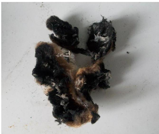
Рис. 4. Образец хлопчатобумажной ваты, подверженный тепловому воздействию ЛНОН мощностью 200 Вт
