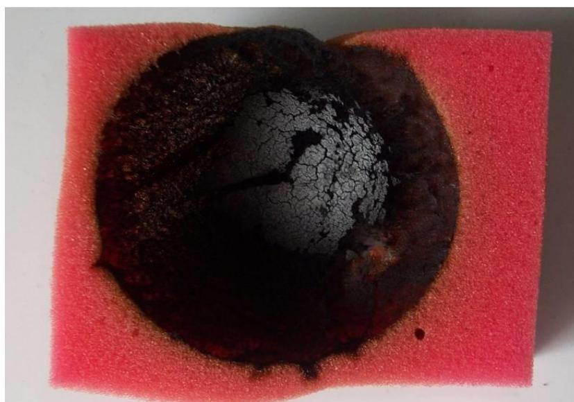
Рис. 10. Образец пенополиуретана, подверженный тепловому воздействию ЛНОН мощностью 200 Вт
