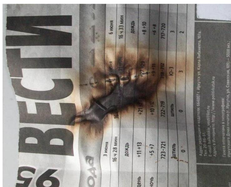
Рис. 8. Образец бумаги офсетной, подверженный тепловому воздействию ЛНОН мощностью 200 Вт
