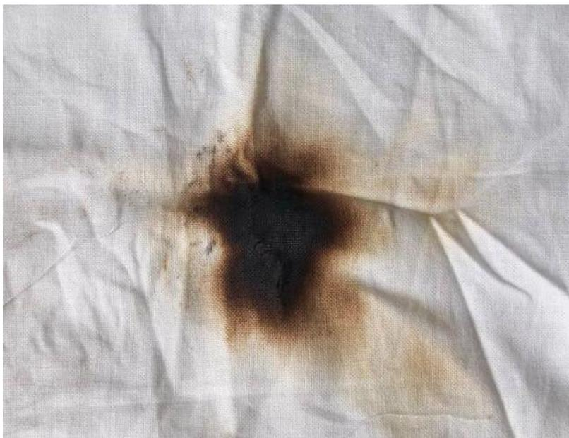
Рис. 5. Образец хлопчатобумажной ткани, подверженный тепловому воздействию ЛНОН мощностью 60 Вт
