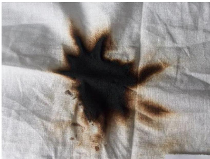
Рис. 6. Образец хлопчатобумажной ткани, подверженный тепловому воздействию ЛНОН мощностью 200 Вт
