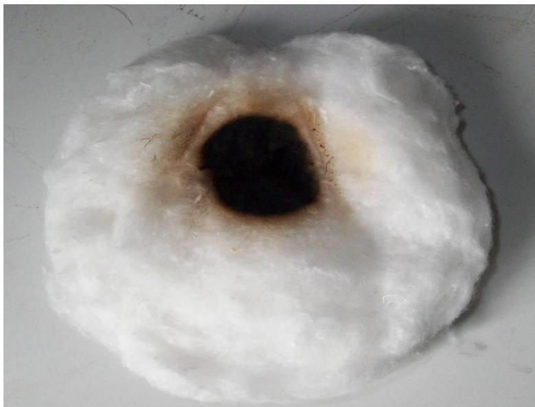
Рис. 1. Образец хлопчатобумажной ваты, подверженный тепловому воздействию ЛНОН мощностью 40 Вт
