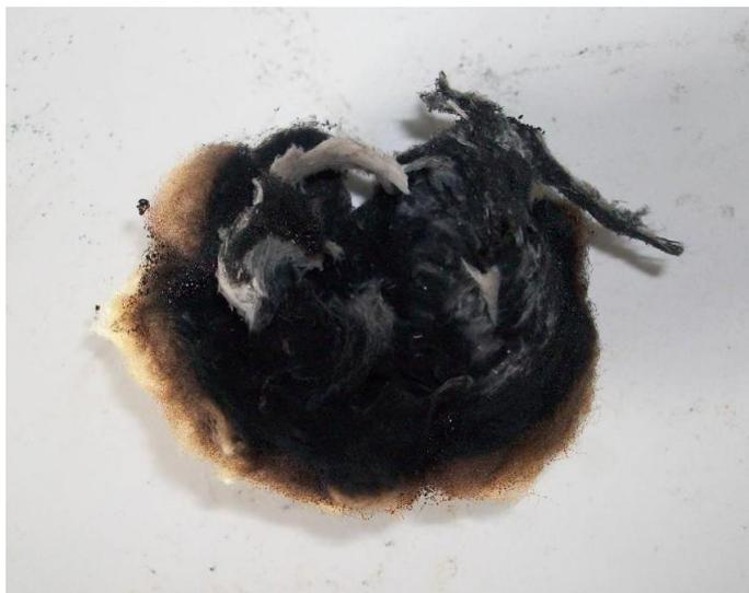
Рис. 3. Образец хлопчатобумажной ваты, подверженный тепловому воздействию ЛНОН мощностью 100 Вт
