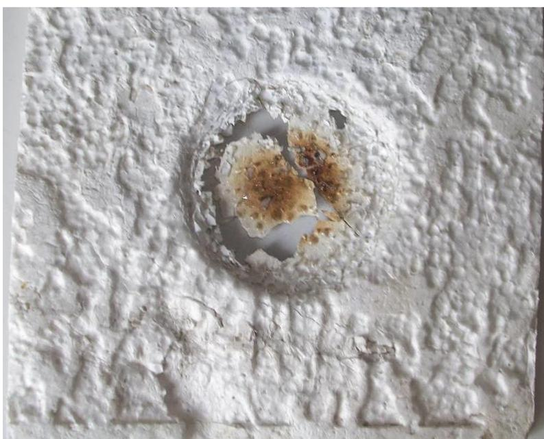
Рис. 12. Образец полистирола (в виде потолочной плитки), подверженный тепловому воздействию ЛНОН мощностью 200 Вт
