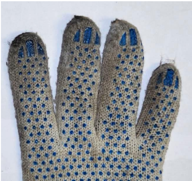
Рис. 37. Пальцевые карманы и подпальцевая зона ладонной стороны корпуса перчатки
