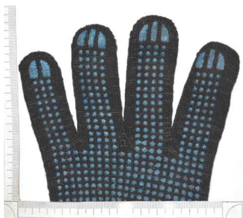
Рис. 5. Пальцевые карманы и подпальцевая зона ладонной стороны корпуса перчатки
