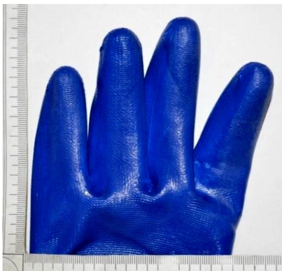
Рис. 9. Пальцевые карманы и подпальцевая зона ладонной стороны корпуса перчатки
