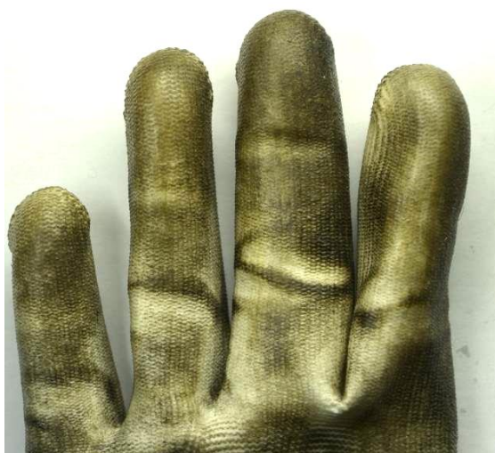
Рис. 29. Пальцевые карманы и подпальцевая зона ладонной стороны корпуса перчатки
