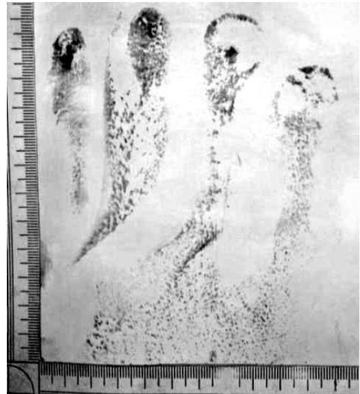
Рис. 14. След пальцевых карманов и подпальцевой зоны ладонной поверхности перчатки
