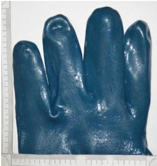
Рис. 13. Пальцевые карманы и подпальцевая зона ладонной стороны корпуса перчатки
