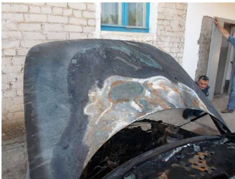
Рис. 1. Термические повреждения на крышке капота автомобиля ВАЗ-2112.
