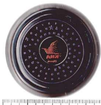
Рис. 2. Рабочая поверхность красконаполненной удостоверительной печатной формы
