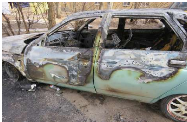
Рис. 3. Термические повреждения на левой (по ходу движения) стороне кузова автомобиля «ВАЗ-2110»
