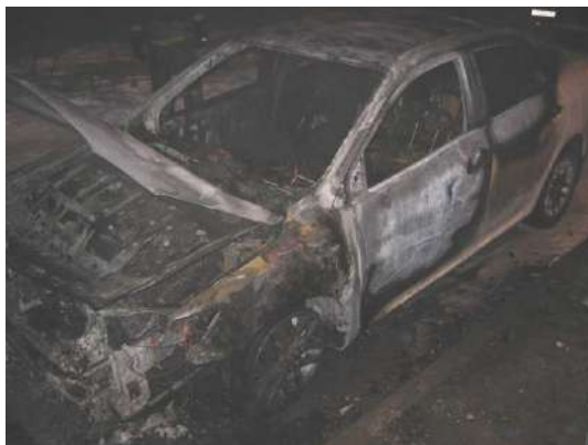
Рис. 2. Термические повреждения на левой (по ходу движения) стороне кузова автомобиля «Тойота Королла»
