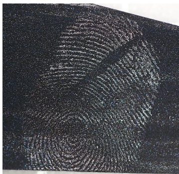
Рис. 20. След пальца руки, оставленный на невысохшем лакокрасочном покрытии лопасти пропеллера БВС
