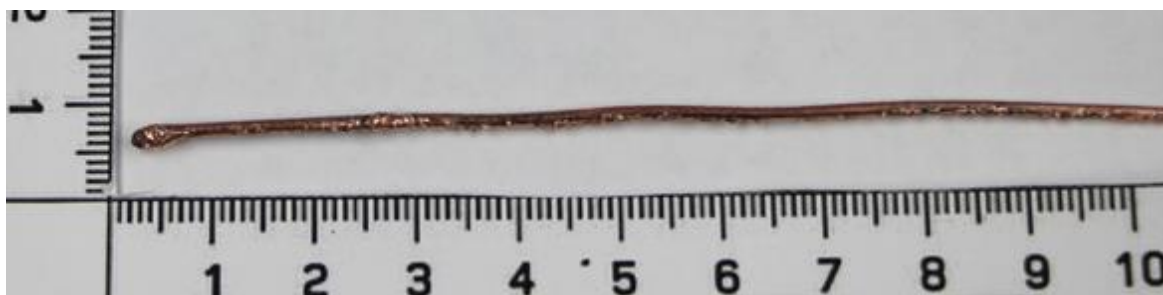
Рис. 1. Повреждения медного проводника в результате теплового действия токов перегрузки (сечение проводника 1,5 мм 2 , кратность перегрузки 3,4)
