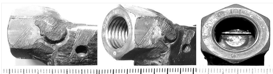
Рис. 6. Изменения в механизме запирания у второй конструкции. Вид с трех сторон по продольной оси
