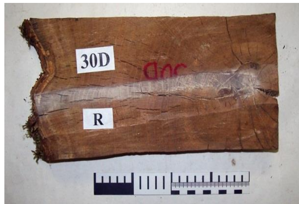
Рисунок 24. Образец древесины (фрагмент спила) № 30D, приготовленный для исследований (R - направление измерений годовых колец древесины)
