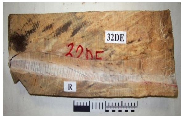
Рисунок 19. Образец древесины (фрагмент спиля) № 32DE, подготовленный для исследований (R – направление измерений годичных колец древесины)
