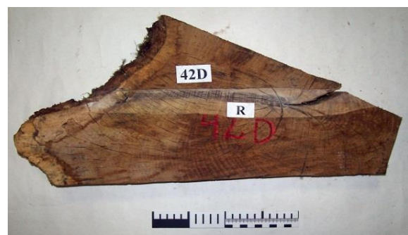
Рисунок 4. Образец древесины (фрагмент спила) № 42D, подготовленный для исследований (R – направление измерений годовичных колец древесины)
