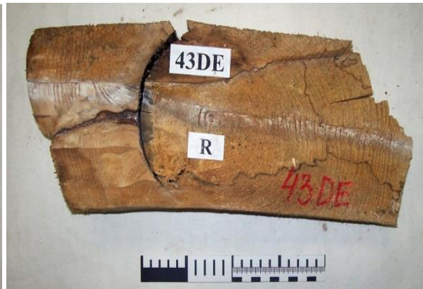
Рисунок 29. Образец древесины (фрагмент спила) № 43DE, подготовленный для исследований (R - направление измерений годичных колец древесины)
