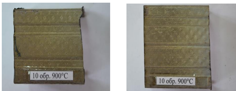
Рис. 7. Профиль стоечный (а) и профиль направляющий (б) при температуре 900°C
