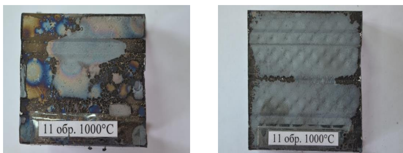
Рис. 8. Профиль стоечный (а) и профиль направляющий (б) при температуре 1000°C
