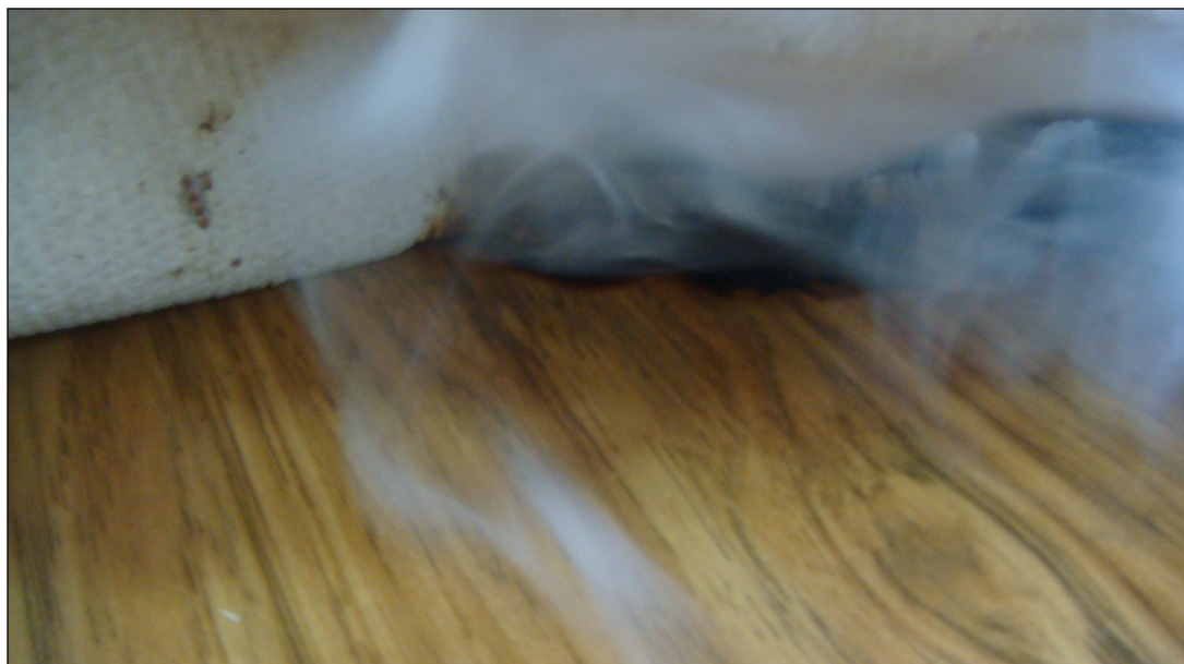
Рис.1. Интенсивное выделение дыма при горении коврового покрытия и линолеума
