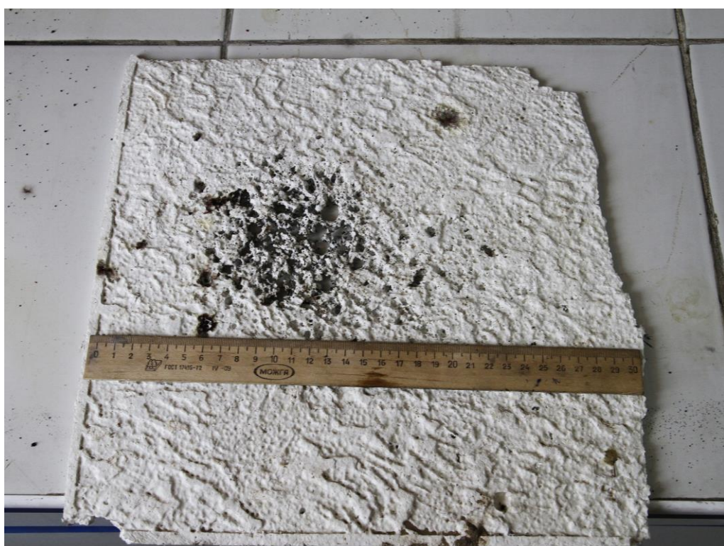
Рис. 8. Результаты воздействия потока искр фейерверочного фонтана на поверхность пенополистирола (потолочная плитка)
