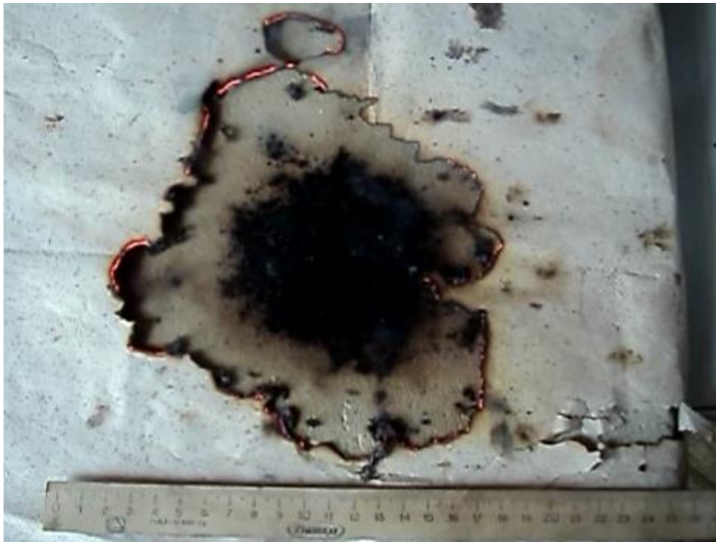
Рис. 11. Результаты воздействия потока искр фейерверочного фонтана на поверхность бумаги
