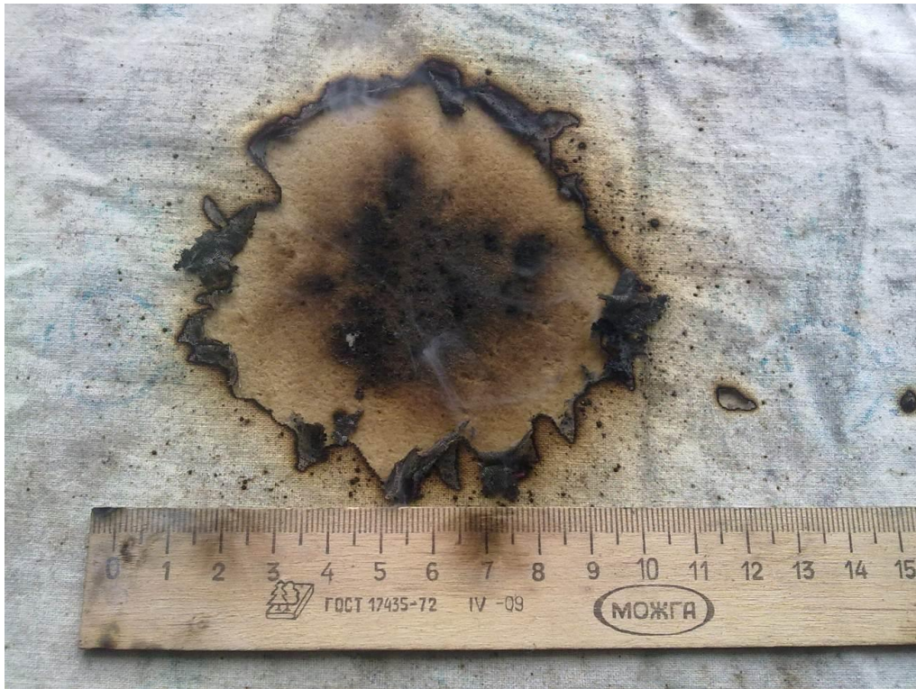
Рис. 9. Результаты воздействия потока искр фейерверочного фонтана на поверхность хлопчатобумажной ткани
