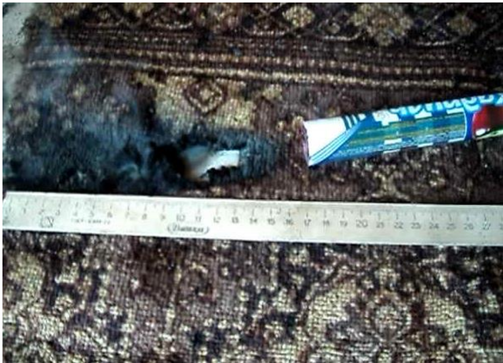
Рис. 10. Результаты воздействия потока искр фейерверочного фонтана на поверхность шерстяного коврового покрытия
