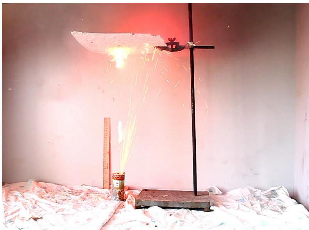
Рис. 7. Проведение исследования зажигательной способности фейерверочного фонтана при контакте искр с пенополистиролом (потолочная плитка)
