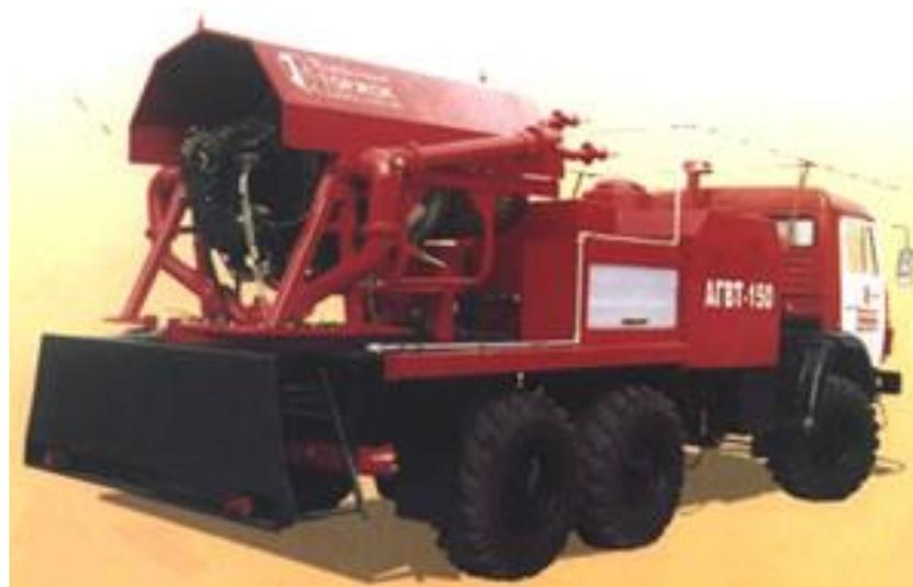
Пожарный автомобиль газоводяного тушения АГВТ-150 (КамАЗ 43114)
