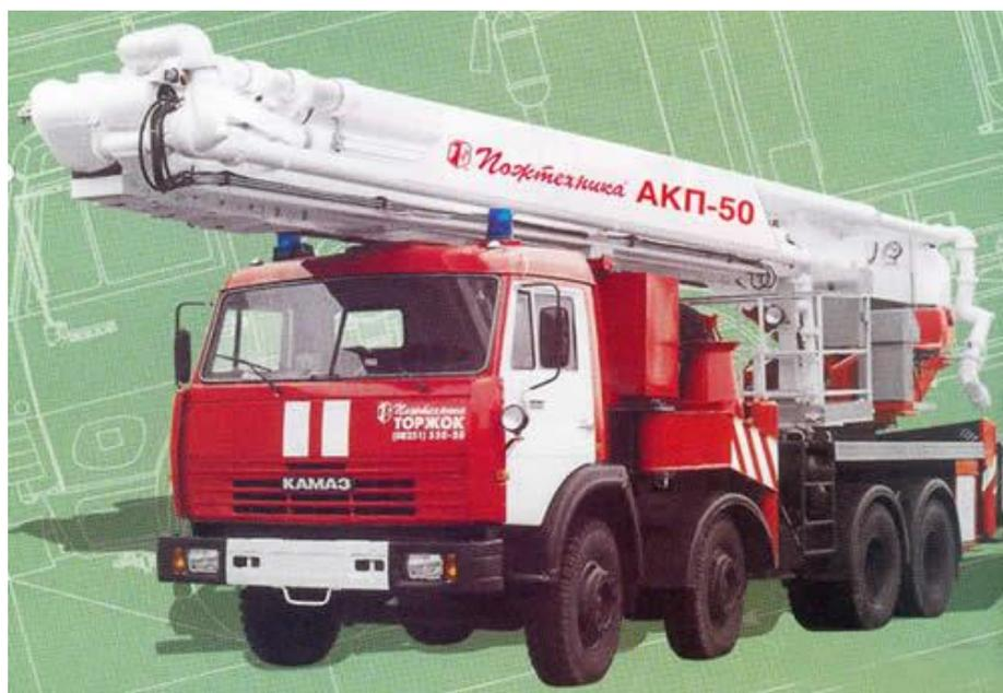
Автоподъемник коленчатый пожарный АКП-50 (КамАЗ-6540)
