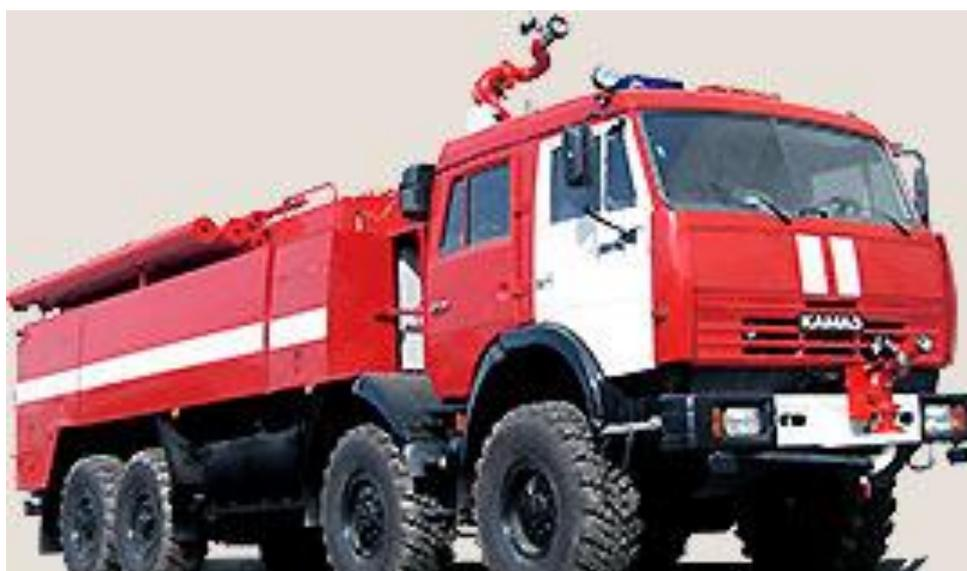
Аэродромный пожарный автомобиль АА 12/70 КамАЗ-63501
