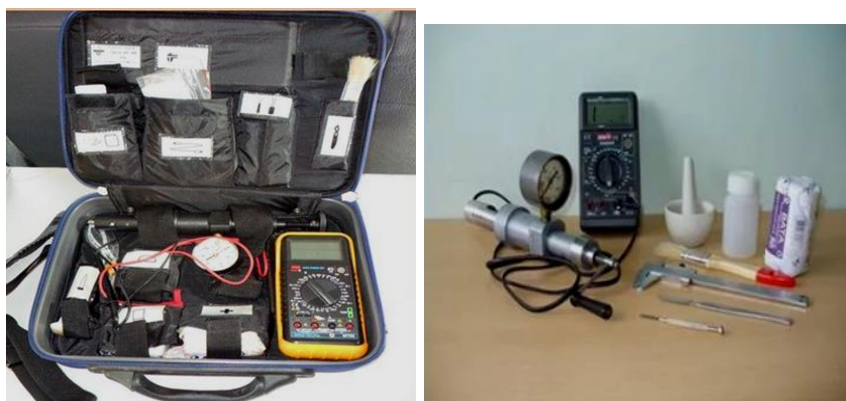
Рис. 1. Комплект «Пирэкс», позволяющий определять электрическое сопротивление постоянному току обугленных остатков ДСМ
